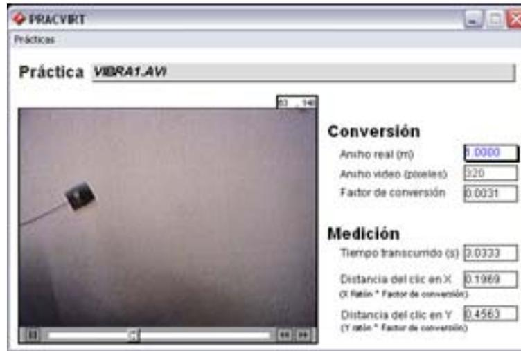
Figura 14. Práctica de una masa oscilando de un fleje de acero
