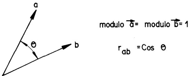
Fig. 3. Representación gráfica de variables. Significado geométrico del coeficiente de correlación de Pearson
