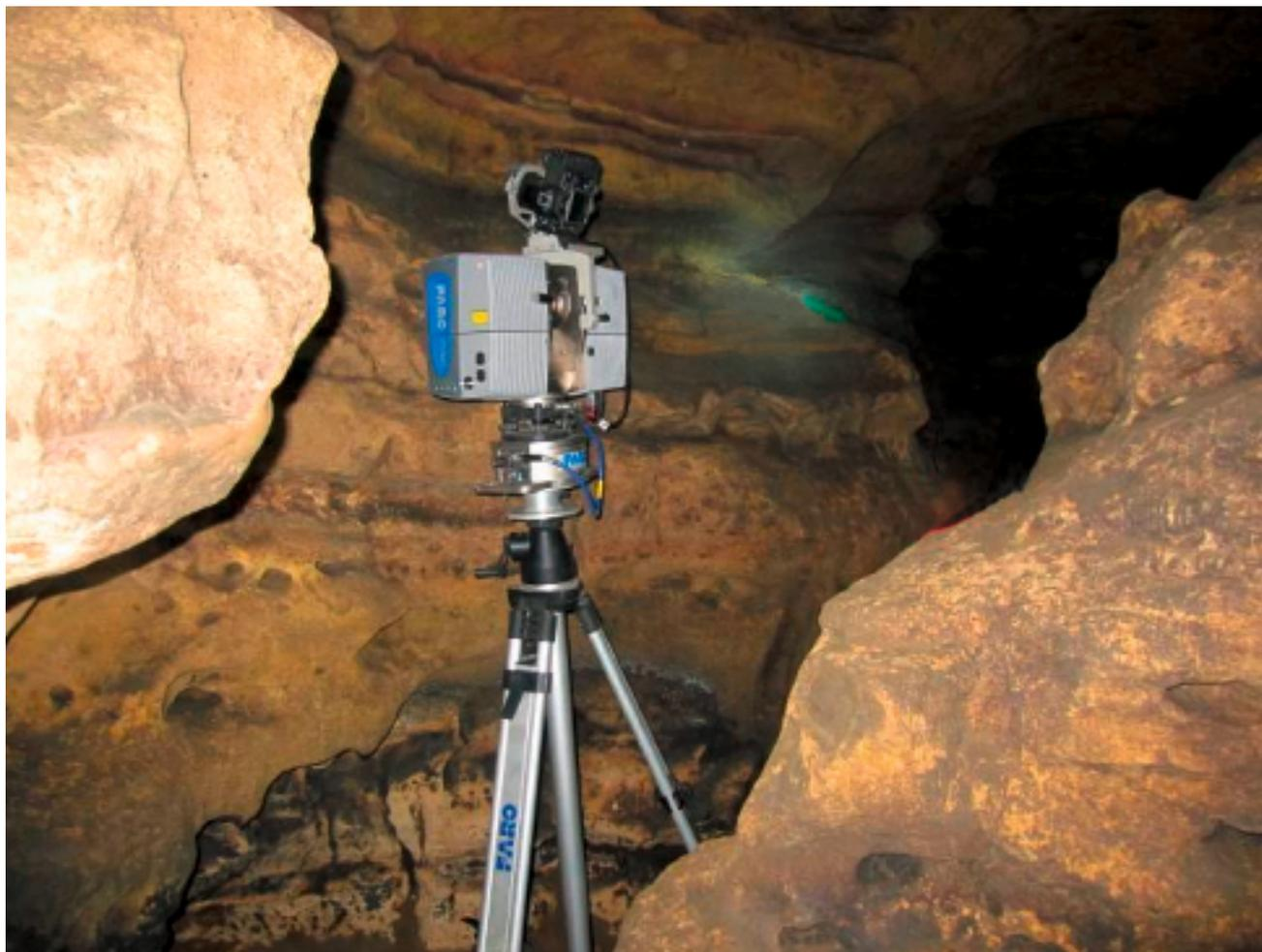
▲ FIGURA 5. Escaneado láser tridimensional. Toma de datos con el escáner Faro Photón 80.
