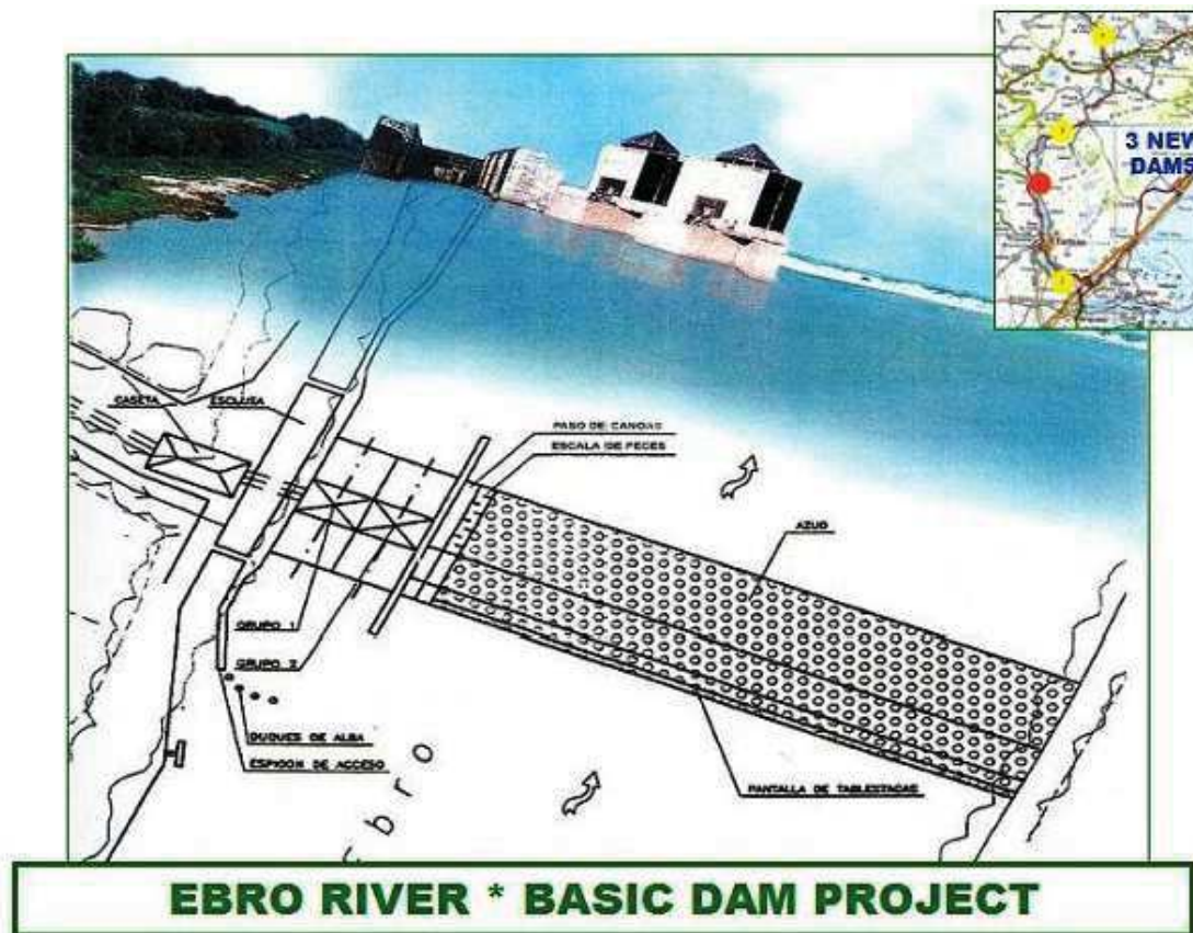
Fig. 34. Detalle de la minicentral hidroeléctrica proyectada.
