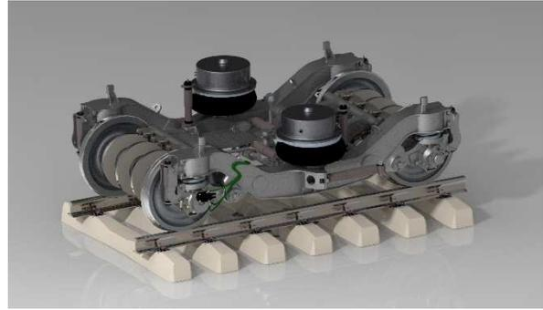
Figura 3. Modelo CAD 3D del bogie desarrollado en CREO Parametric.
