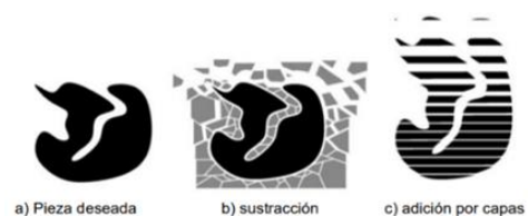
Figura 1. Concepto de fabricación sustractiva comparada con AM [3].
