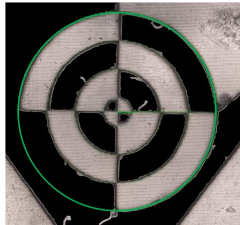
Figura 16. Medición de los diámetros externos teniendo como referencia el contorno de las regiones expuestas mediante las máscaras de capa.
