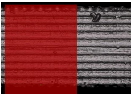
Figura 14. Mediciones de espesor de pared delgada 500 \mu\text{m} utilizando 1000 planos de corte. Pieza fabricada con un tiempo de exposición de 1,4 s.
