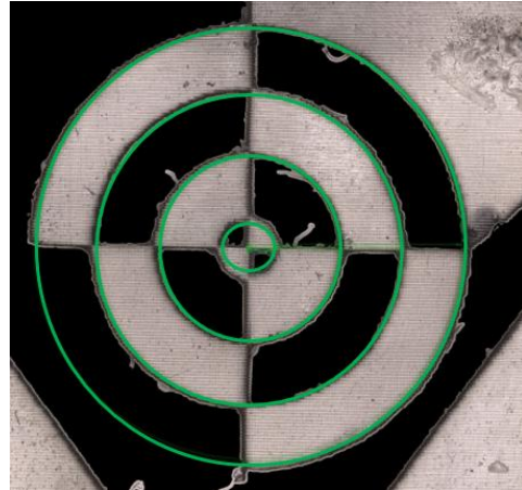
Figura 17. Medición de los diámetros internos teniendo como referencia el contorno no expuesto.
