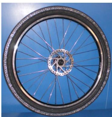
**Figura 14.** Imagen del prototipo fabricado sin la banda de rodadura instalada [19,20]. Fuente: Advantaria/Mixtire.
