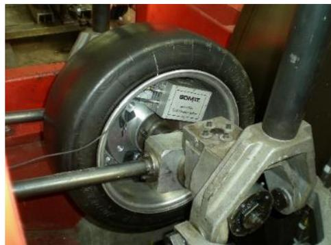
Figura 5. Equipo de adquisición y acondicionamiento de datos SoMat® 2000 instalado en la llanta.
