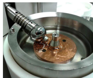
Figura 1. Máquina MTM donde se muestra el baño de lubricante y el contacto bola-disco [20].
