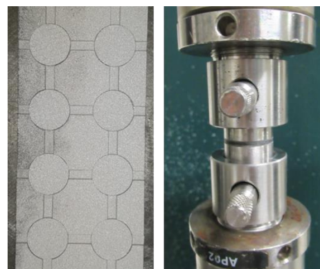
Figura 7. Probetas pretratadas y recubiertas (izq) para la ejecución del ensayo de adhesión (der).
