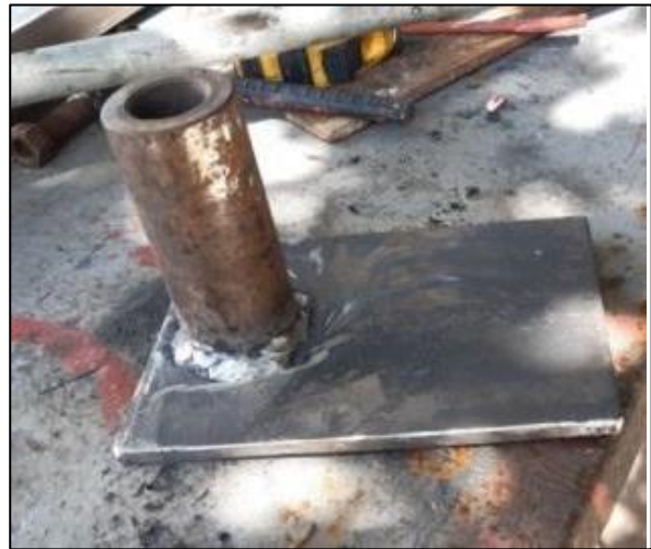
Figura 2. Bujes soldados a la platina.
