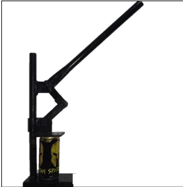
Figura 8. Prensa manual en posición de aplastar una lata de bebida energizante.
