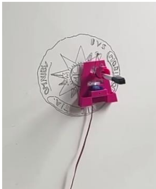
Figura 6.1: Plotter vertical trazando la imagen del escudo de la UNED, finalizado y testeado.
