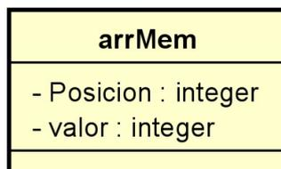
Figura 7.8: Estructura tipo array de dos dimensiones para almacenar el estado del cómputo.
