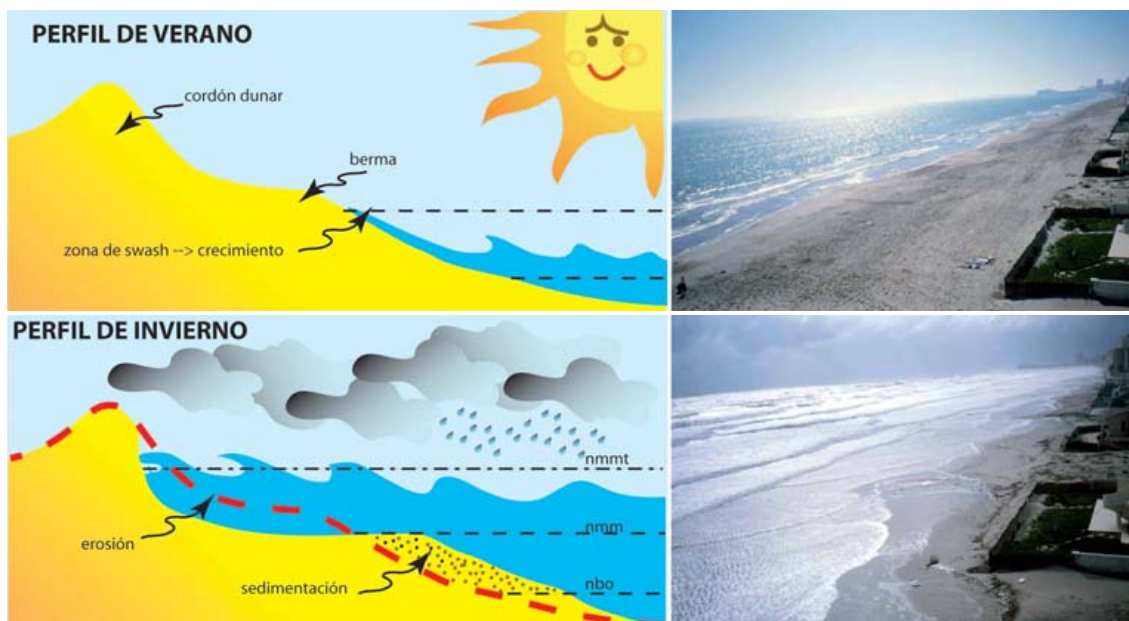
Fig. 4. Comparación entre los perfiles de verano, con baja altura del oleaje y menor energía, y de invierno, con mayor altura de oleaje y mayor energía. A la derecha imágenes de la Manga del Mar Menor correspondientes a la playa en situación anticiclónica (perfil de verano) y de borrasca (perfil de invierno).
