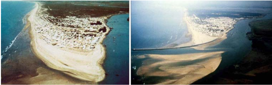
Fig. 15. Desembocadura de los ríos Tinto y Odiel. Flecha de Punta Umbría antes de la construcción del dique Juan Carlos I (izquierda) y tras la construcción del mismo (derecha). El océano atlántico a la izquierda y la entrada al estuario a la derecha. La deriva litoral del fondo de la foto hacia el frente (ESE).
