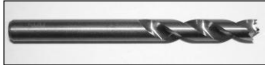
Fig. 2. Broca “Brad & Spur” de carbonetos sinterizados (K10) utilizada nos ensaios de furação.
