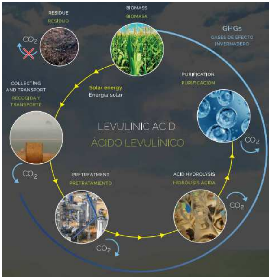
Figura 12. Esquema del proceso WALEVA desarrollado por Técnicas Reunidas
