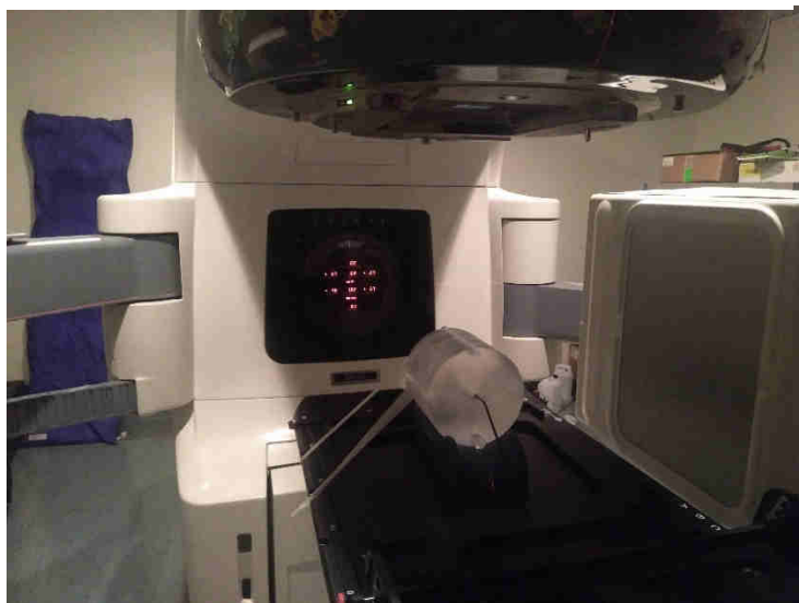
Figura 48. Maniquí de medida de dosis CBCT, cámara lápiz y electrómetro
