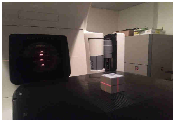
Figura 34: Alineación del maniquí de verificación de isocentro con los láseres externos.
