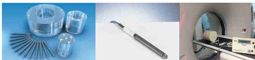
Figura 22. Maniquí cilíndrico de PMMA de QUART. Cámara de ionización tipo lápiz de PTW y electrómetro RadCal para la medida del CTDI.
