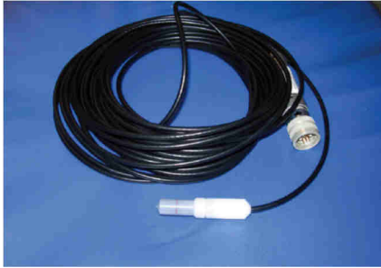
Figura 24. a) Cámara de ionización RadCal "tipo Farmer" de 0.6 cm 3 . b) Maniquí cilíndrico de 50 cm de longitud con alojamiento en el eje central para la cámara Farmer.
