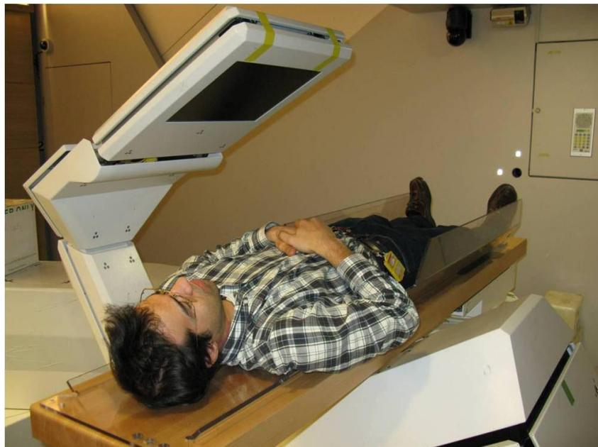
Ilustración 22 Detalle de la mesa de pacientes de Gantry 2 en PSI, con la que tiene que ser compatible el sistema de posicionamiento. Fuente: [6]
