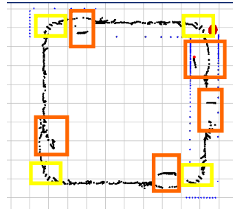
Discontinuidades en esquinas, encuadradas en amarillo, y en las colisiones que se producen tanto al iniciar el movimiento como al girar en las esquinas, encuadradas en naranja
