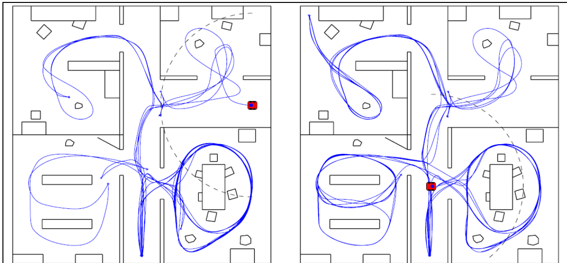
Figura recogida de [Z]: capacidad del método parcial del centro de áreas para recorrer zonas de espacio libre, posicionando el robot en diferentes orígenes
