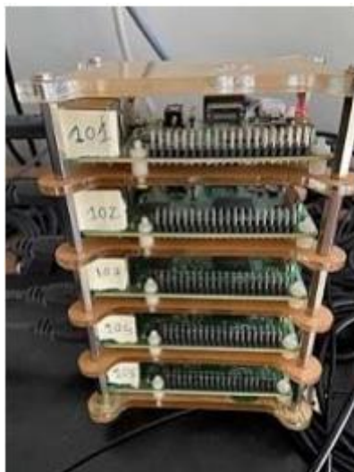
Figura 2-1: foto del clúster físico de Raspberry Pi para LoT@UNED. Imagen extraída de (eNMoLabs P. , Entregable 2.2, 2020)
