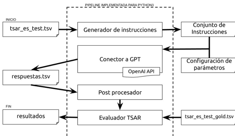
Figura 4.1: Representación del sistema utilizado para los experimentos
