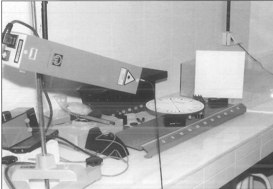
Laboratorio de Óptica: espectrogoniómetro.
