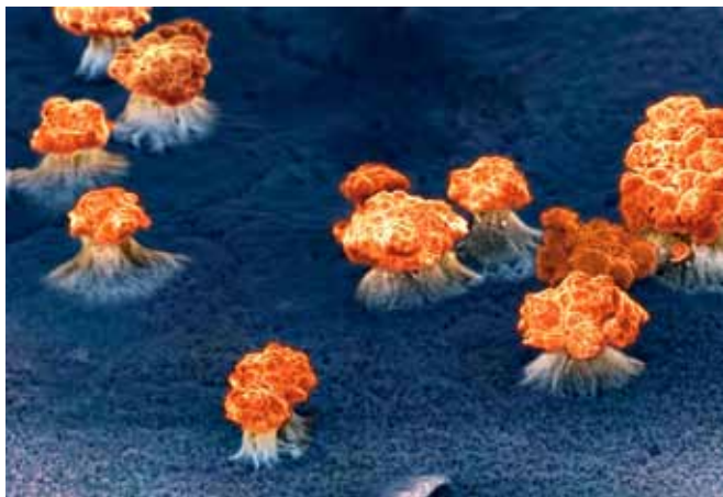
Figura 3. Micrografía electrónica de barrido de nano-cables de CoFeB, obtenidos por electrodeposición sobre una superficie de alúmina nanoporosa por Fanny Béron, de la École Polytechnique de Montreal (Canadá). Según Chem Eng. News. , 85 , 24, diciembre 2007.
