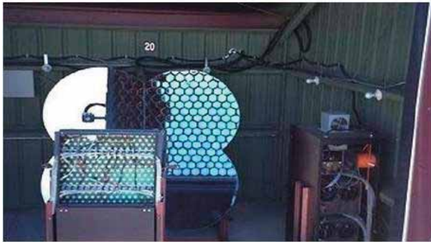
Figura 9. Algunos de los espejos del detector de fluorescencia Fly's Eye (arriba). Uno de los telescopios del proyecto HiRes (abajo).
