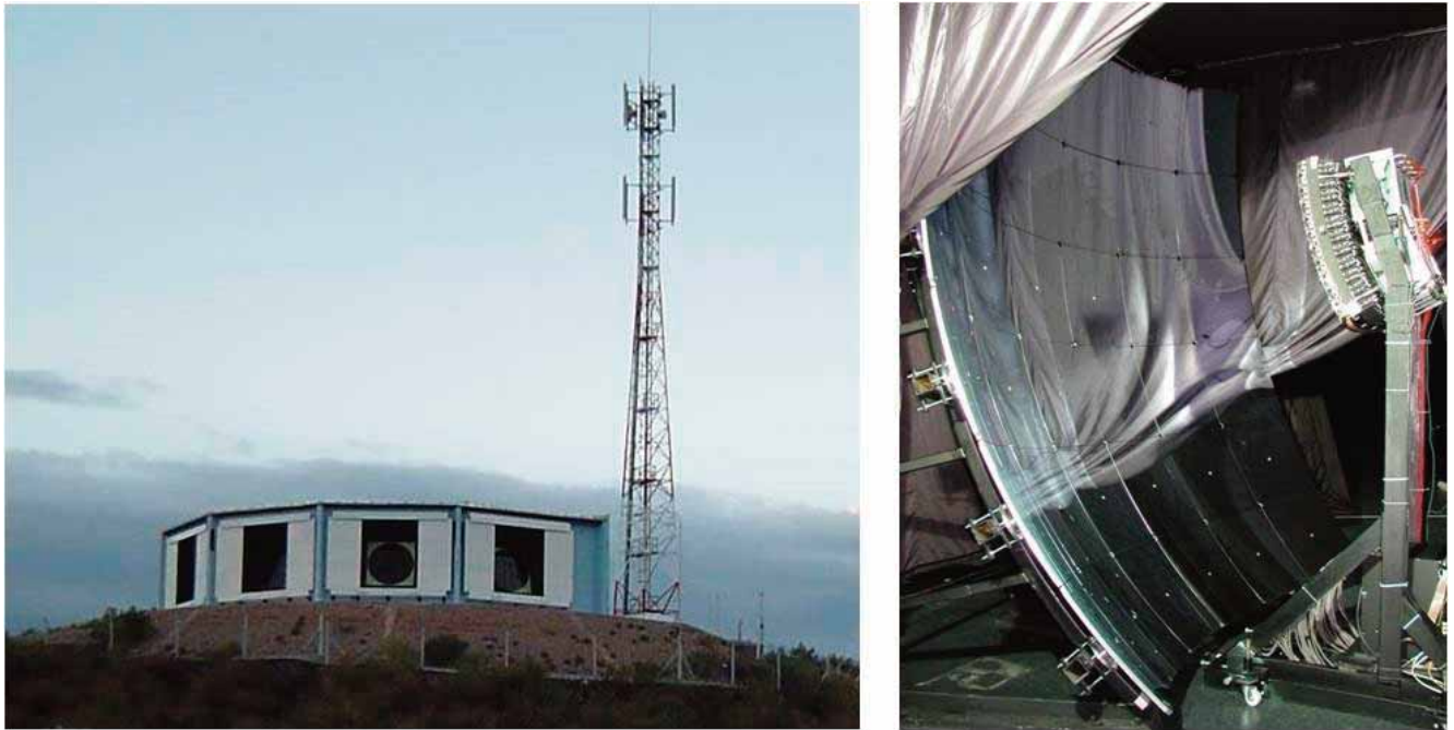
Figura 12. Detector de fluorescencia del Observatorio Pierre Auger. Cada una de las estaciones (izquierda) consta de cuatro telescopios, uno de los cuales se muestra en la figura (derecha).
