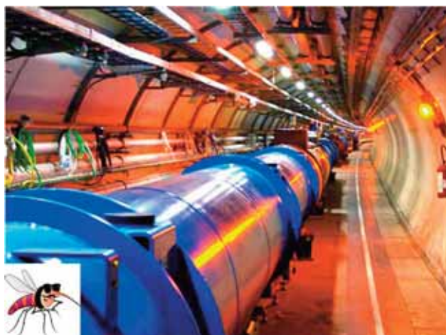
Figura 1. El gran colisionador de hadrones LHC en el CERN podrá acelerar protones hasta una energía de 7 TeV. Cada protón tendrá la misma energía cinética que un mosquito en vuelo, 1 \mu J.
