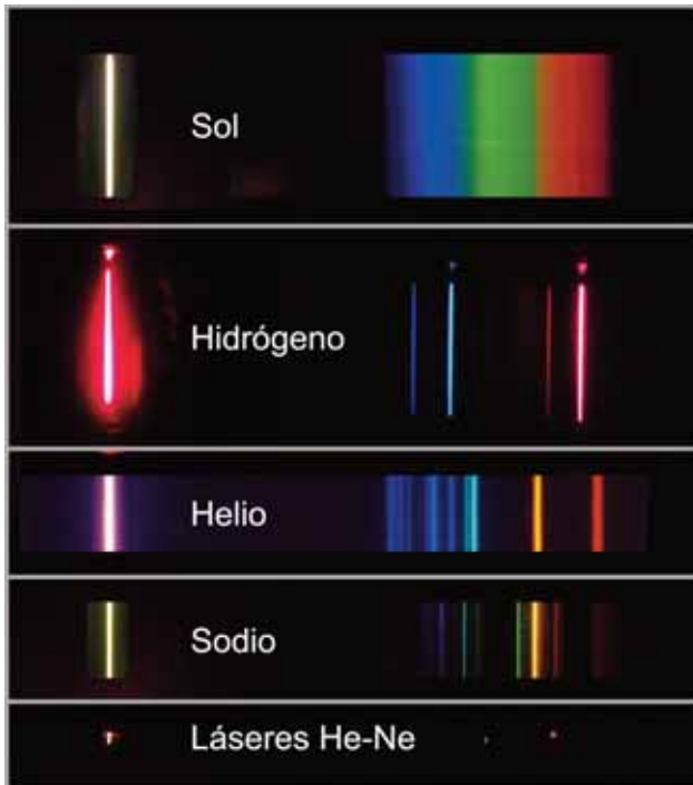
Figura 15. Espectros del Sol, los tubos de descarga de hidrógeno, helio y sodio y de dos láseres de He-Ne (rojo y verde), obtenidos con una cámara digital y nuestro espectroscopio.
