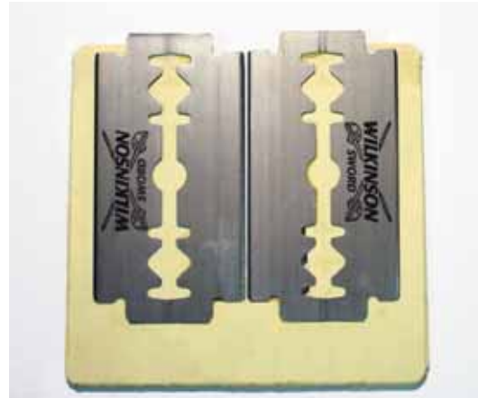
Figura 8. Fotografía de la rendija de entrada utilizada en nuestro espectroscopio.
