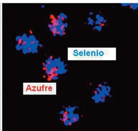
Figura 5. Izquierda: Eficiencia de células solares formadas por nanocristales de Pb S_x Se_{(1-x)} en función de la concentración de azufre, desde PbSe puro hasta PbS puro. Se inserta la curva de funcionamiento de la composición óptima. Derecha: Distribución de azufre (en rojo) y selenio (en azul) dentro de algunos nanocristales. Según Ma y col., 2009.
