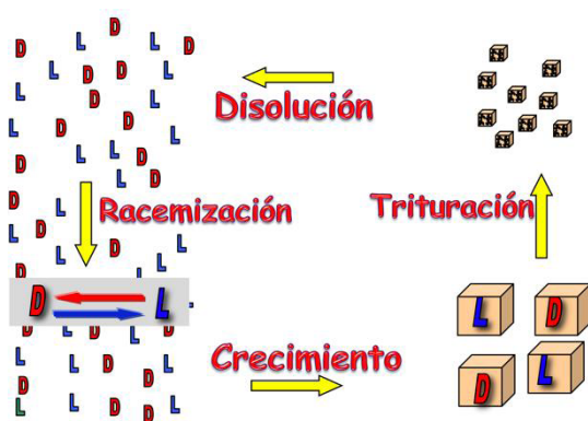
Figura 10. La racemización en disolución de moléculas quirales permite que un sistema compuesto por dos enantiómeros cristalinos, formados por moléculas quirales, evolucione hacia una fase sólida con una única quiralidad.
