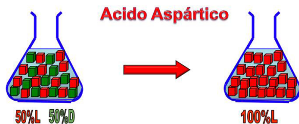
Figura 11. Un sistema con los dos enantiómeros del ácido aspártico sometido a molienda y racemización se transforman en otro de pureza quiral.
