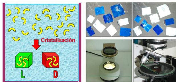
Figura 6. La molécula \text{NaClO}_3 , del clorato sódico no es quiral pero los cristales que forman si son quirales debido a su eje helicoidal. La identificación de los cristales que poseen la misma mano es posible gracias al uso de la luz polarizada y la rotación de uno de los polarizadores.
