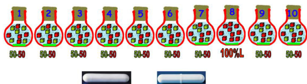
Figura 7. Los sistemas con una población inicial de cristales quirales 50%-50% en suspensión en el seno de una disolución saturada permanecen sin cambios cuando usamos un agitador liso; sin embargo, alcanzan una sola quiralidad cuando el agitador tiene un anillo en el centro (sistema 8).
