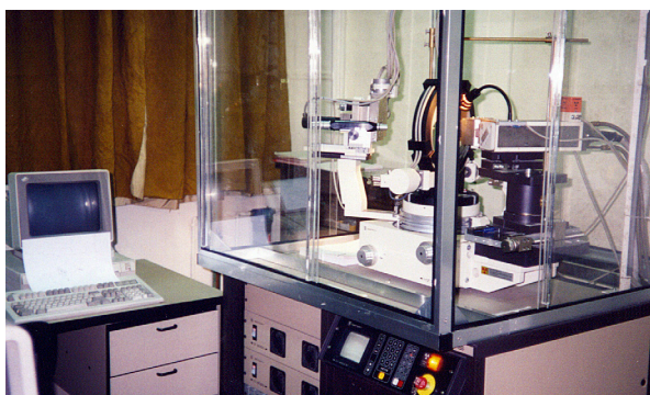
Figura 15. El difractómetro de 4 círculos Seifert, programado a la carta.
