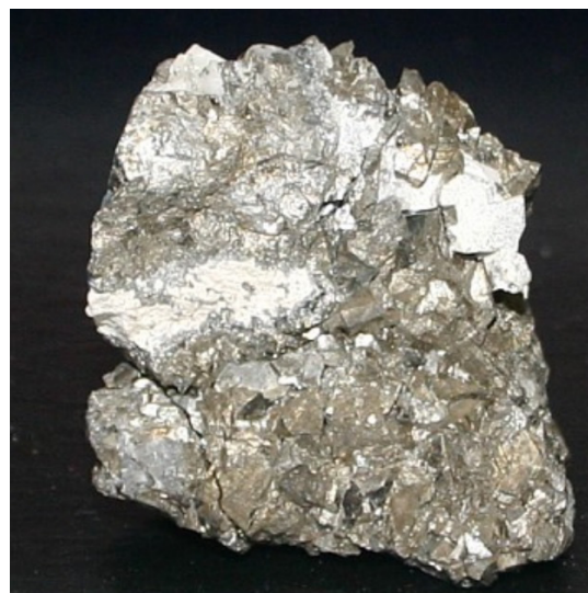
Figura 2. El mineral arsenopirita es abundante en arsénico y se utiliza como fuente de obtención a nivel industrial. Fuente: http://nevada-outback-gems.com/mineral_information/arsenopyrite_mineral_info.htm .
