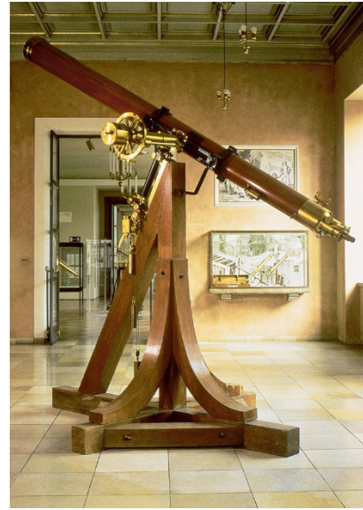
Figura 7. Telescopio refractor de 9 pulgadas (Deutsches Museum, Múnich), construido conforme al diseño de Fraunhofer. Fuente: Corporación Fraunhofer-Gesellschaft.
