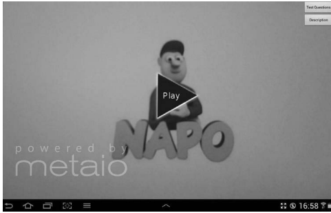
Figura 10. Reconocimiento del Patrón – El patrón es reconocido y el recurso virtual se superpone sobre él. En este caso el recurso virtual es un botón de PLAY el cual permite interactuar al usuario con un video en formato 3G2
