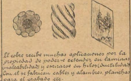
El cobre recibe muchas aplicaciones por la propiedad de poderse extender en laminas maleabilidad y estrarse en hilos (ductilidad). Con el se fabrican cables y alambres, planchas para el grabado etc.
