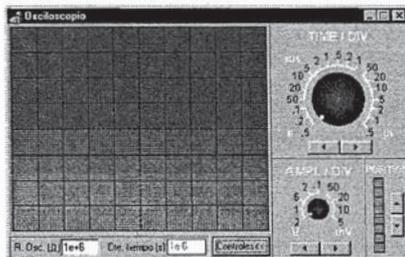
**Fig. 3:** Pantalla del osciloscopio virtual. Mediante los botones pueden ajustarse las escalas temporal y vertical.
