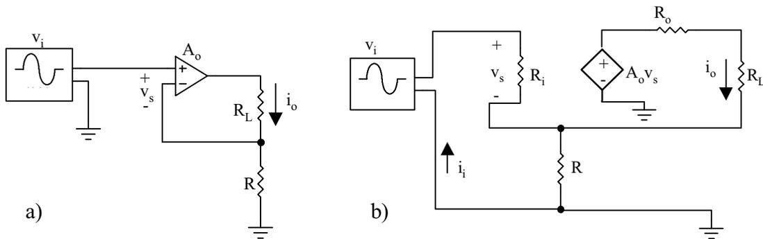
**Figura 2:** a) Amplificador operacional con realimentación serie-serie. b) Circuito equivalente.
