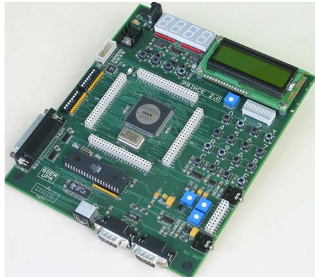
Figura 1. Diagrama de bloques y aspecto de la tarjeta PRINCE
