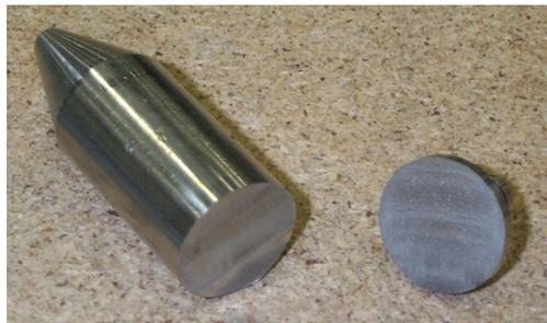
Figura 18 Corte de una pieza por electroerosión
