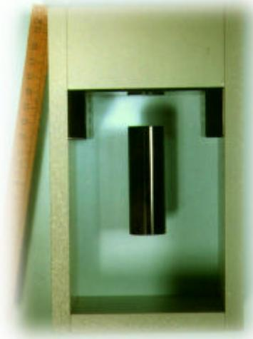
Figura 8: Equipo de levitación magnética de bajo coste
