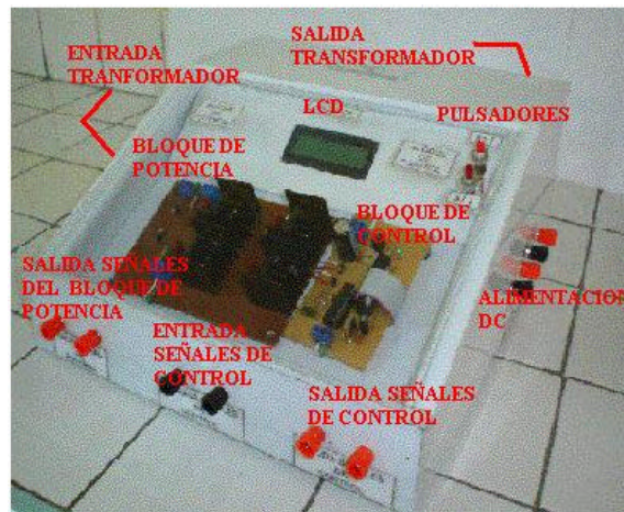
Figura 9. Disposición final del inversor monofásico didáctico.
