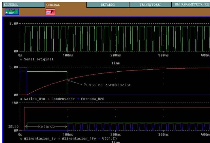
Figura 7. Simulación Pspice del generador de impulsos de la Fig.4.
