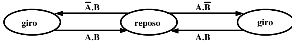
Figura 1. Grafo de estados de un motor controlado por dos pulsadores A y B.
