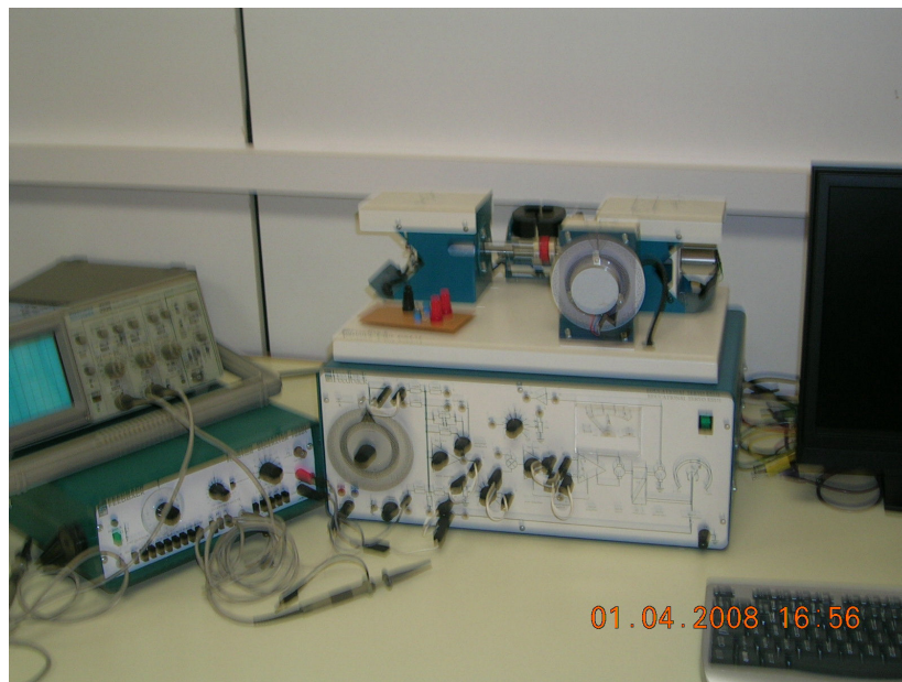
Figura 7. Proceso de laboratorio: servosistema, control de posición/velocidad
