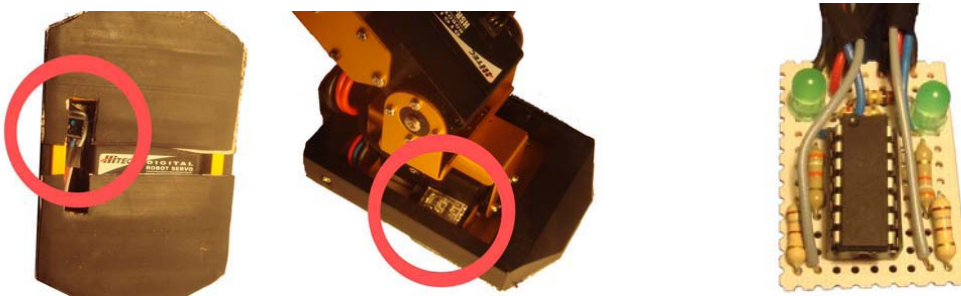
Figura 5. Colocación de los sensores optorreflectivos en los pies del Robonova I y circuito acondicionador.
