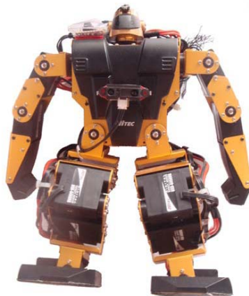
Figura 4. Colocación del sensor de infrarrojos en el tronco del Robonova I.
