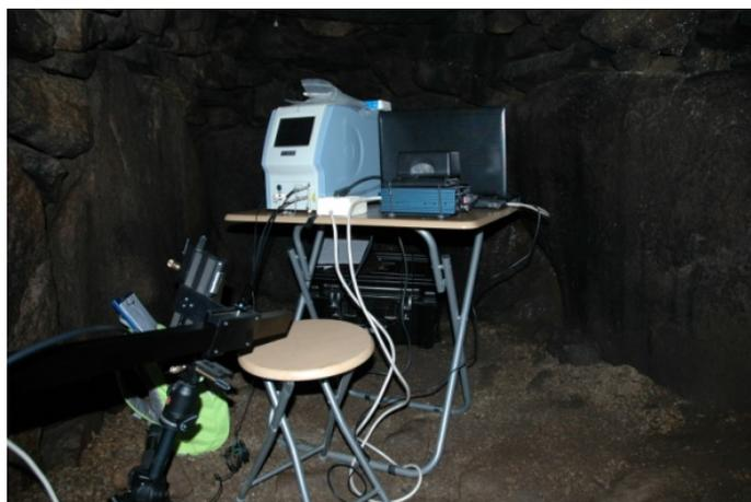
**Figura 25.** Imagen del microscopio portátil BWTEK InnoRam 785H montado en el interior de una cueva.
