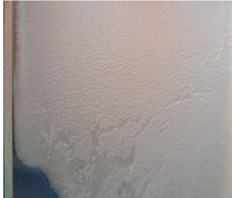
Figura 4.20. Imagen en detalle de la deposición de la película orgánico – inorgánico sobre placa de vidrio mostrando heterogeneidades en la distribución.
