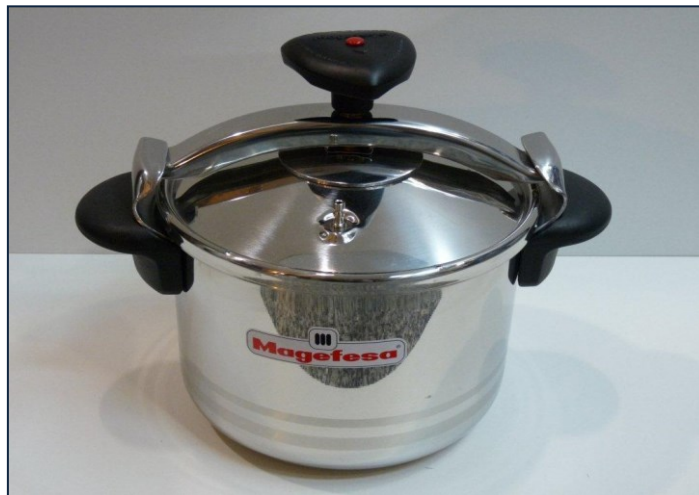
Figura 3.6 Modelo de olla de presión doméstica empleada como reactor en el escalado.
