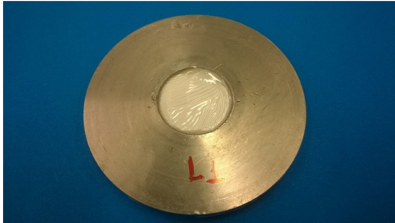
Figura 3.14. Imagen del sistema del soporte cerámico con la membrana objeto de análisis, situado sobre el portamuestras para el ensayo de permeabilidad.
