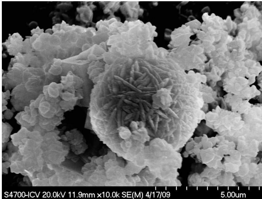
Figura 4.14. Micrografía MEB de los precipitados obtenidos por síntesis hidrotérmal en el intervalo de 120 min empleando la relación molar 34 \text{ Na}_2\text{O} : \text{Al}_2\text{O}_3 : 3 \text{ SiO}_2 : 462 \text{ H}_2\text{O} .
