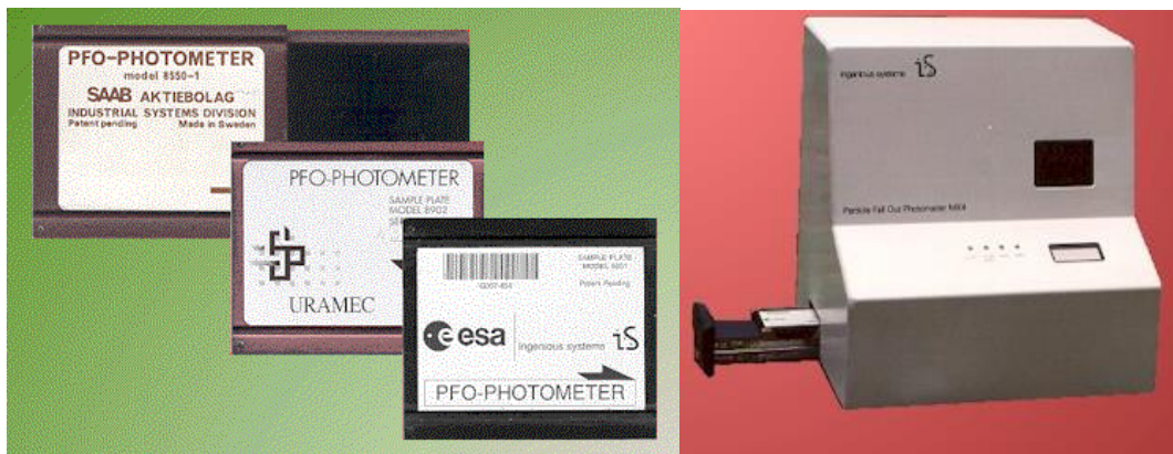
Imagen 1-12: (Izquierda) testigos de contaminación de partículas. En el del fondo puede verse la placa de sensor (en negro) descubierta. (Derecha) Medidor fotométrico de PFO. El testigo se coloca en el acceso de la izquierda y el equipo lo introduce, destapa y analiza automáticamente.
