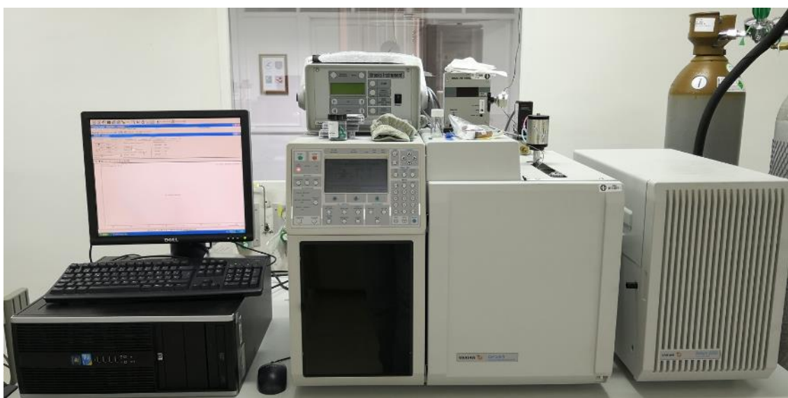
Imagen 6-5: Cromatógrafo de gases con espectrómetro de masas utilizado en el estudio.
