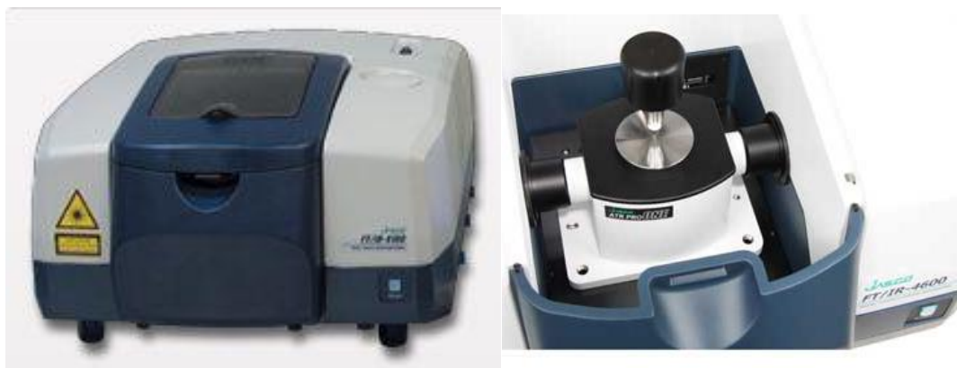
Imagen 6-4: (Izquierda) imagen del equipo Jasco FTIR-4200 utilizado. (Derecha) detalles del módulo ATR de análisis.
