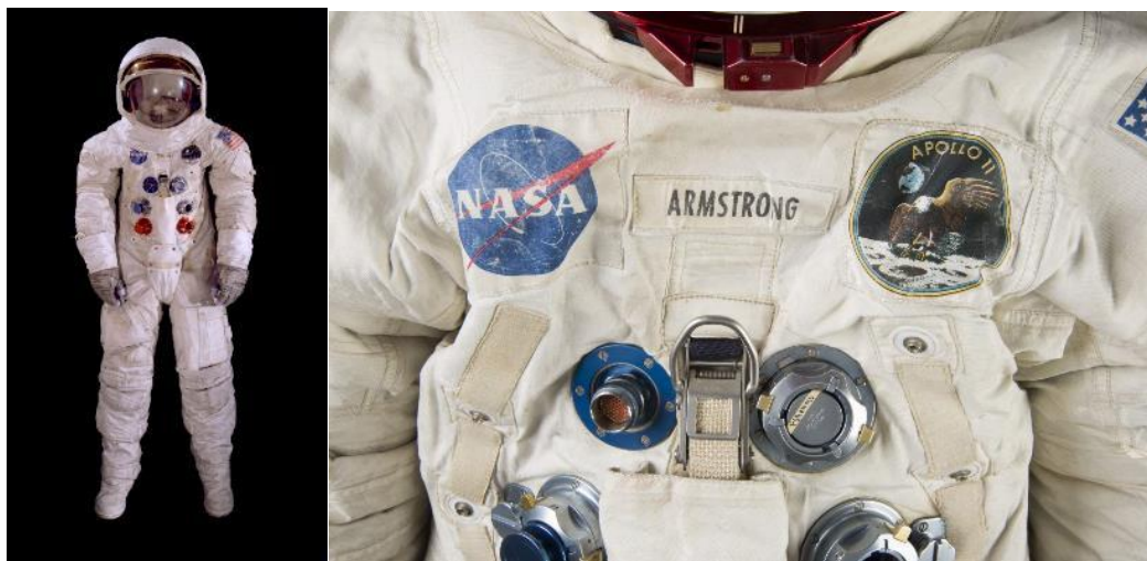
Imagen 1-13: El traje presurizado de Neil Amstrong con el que realizó el primer paseo lunar de la historia, fabricado por ILC Industries Inc., tenía en su composición neopreno, nylon, gomas y algún plástico.
