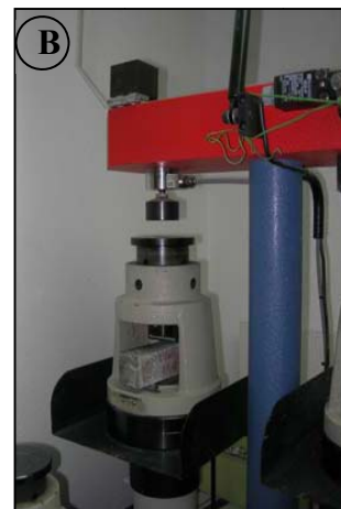
Figura III.5.1. A) Equipo Netzsch para rotura a flexotracción de las probetas de pasta. B) Prensa empleada para la rotura de las probetas prismáticas de mortero (flexión y compresión) y de pasta (compresión).
