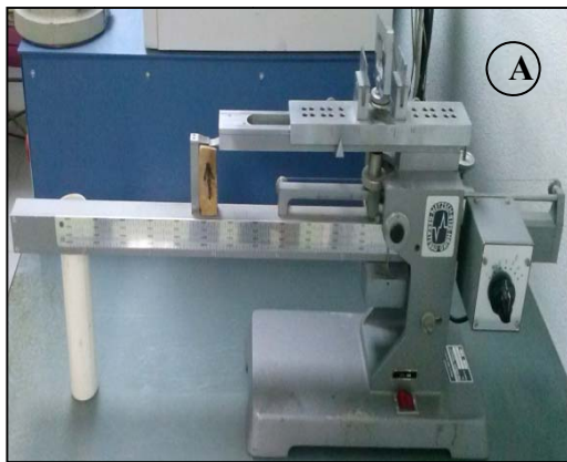
Figura III.5.1. A) Equipo Netzsch para rotura a flexotracción de las probetas de pasta. B) Prensa empleada para la rotura de las probetas prismáticas de mortero (flexión y compresión) y de pasta (compresión).
