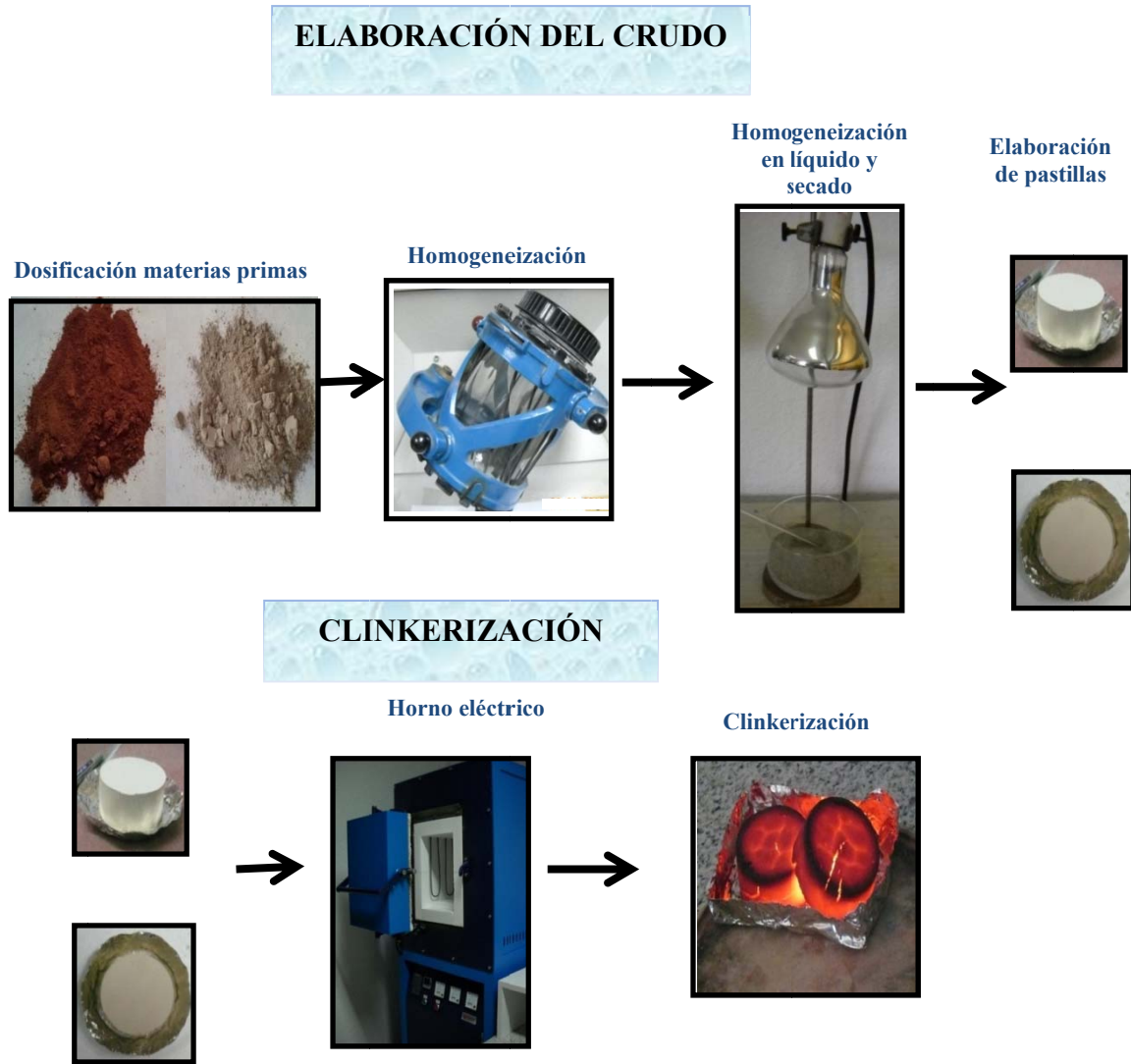
Figura III.2.1. Proceso de elaboración del crudo y clinkerización.
