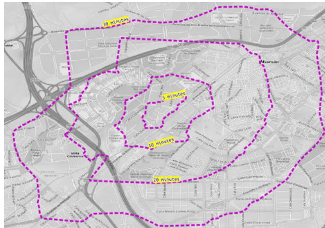
Figura 4.5. Anillos de isócronas son las áreas accesibles a pie a 5, 10, 20, 30 minutos desde una ubicación semilla
