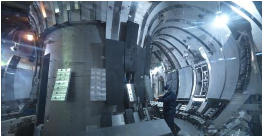
Figura 3.12. Cámara de vacío donde se destacan sus dimensiones (© CCFE) [URL, 45] .
