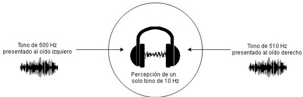
Figura 4.2.1: Integración binaural de dos tonos puros de 500 Hz y 510 Hz en un solo tono que será la diferencia de frecuencias entre ambos tonos, en este caso de 10Hz.
