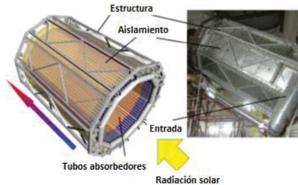
Fig. 2.35. Imagen Receptor tubular para gases presurizados desarrollado en el proyecto SOLUGAS [110]
